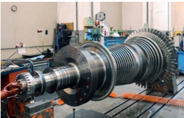
Turbinenrotor im Werk der Firma De Pretto.
